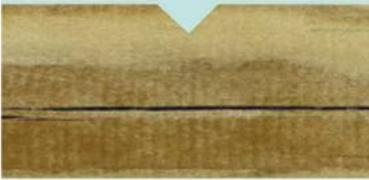
Le bois, hétérogène par nature, est soumis aux variations de température et d'humidité. En séchant, il se rétracte de façon irrégulière entraînant l'apparition de fentes. Celles-ci peuvent être impressionnantes mais ne nuisent en rien aux caractéristiques du produit et n'entrent pas dans le cadre de la garantie.
